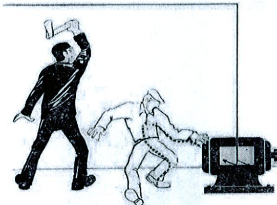
Rys. 22. Uwolnienie porażonego spod działania prądu elektrycznego o napięciu do 1 kV przez przecięcie lub zerwanie przewodów od strony zasilania
